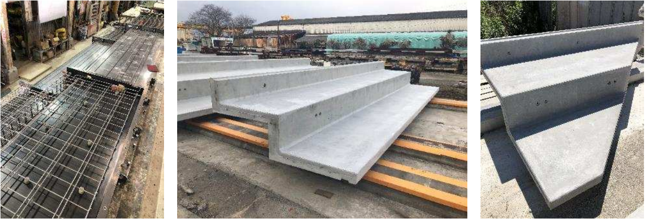
写真-7 PC 段床版製作状況
