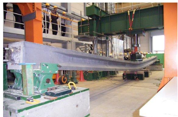
写真-2 曲げ破壊実験状況
