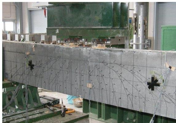
写真-3 せん断破壊実験状況
