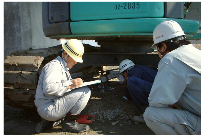
写真-5 地耐力確認試験
