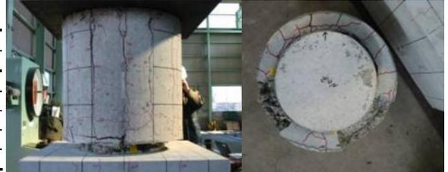
図-7 最終破壊状況
