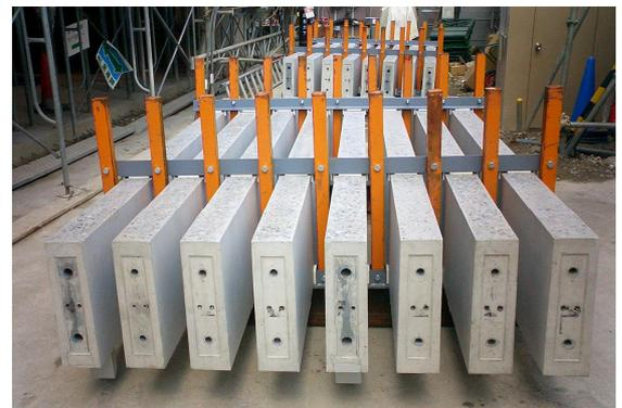
写真-7 PCa 柱運搬用架台
