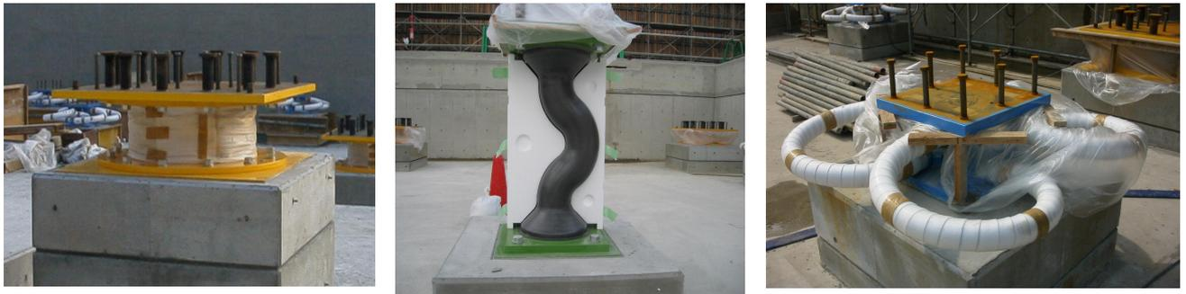
写真-3 免震装置(左よりアイソレータ,鉛ダンパー,鋼棒ダンパー(白い部分養生材))
