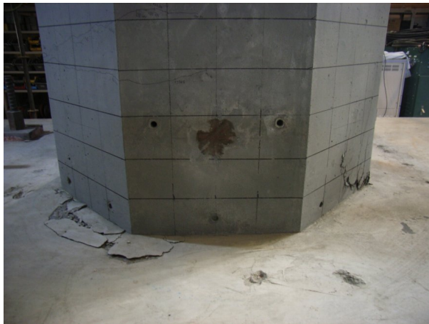
写真-24 破壊状況(基部拡大)
