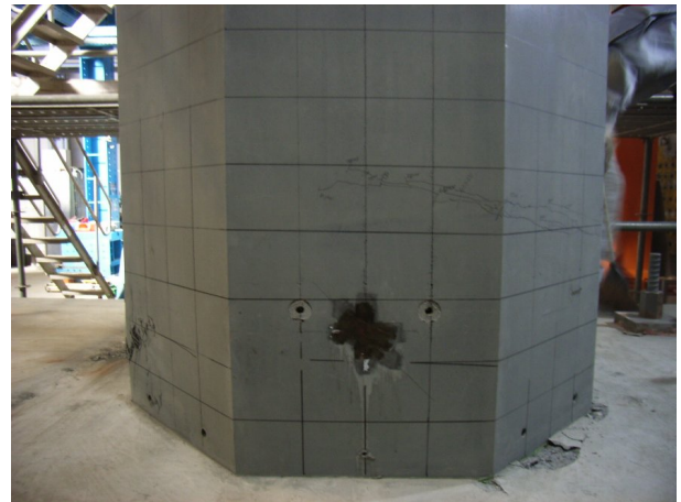
写真-24 破壊状況(基部拡大)
