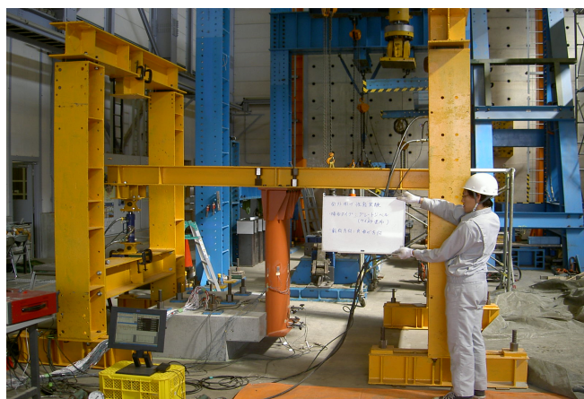
写真-2 面外方向曲げ抵抗性能確認実験
