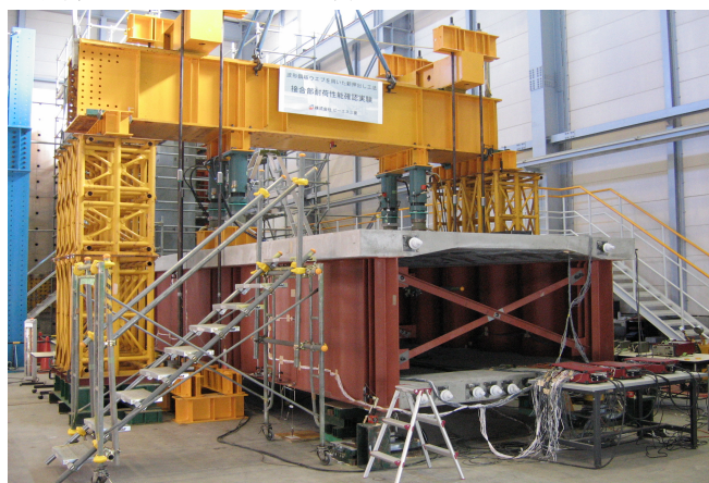
写真-1 ずれせん断抵抗性能確認実験
