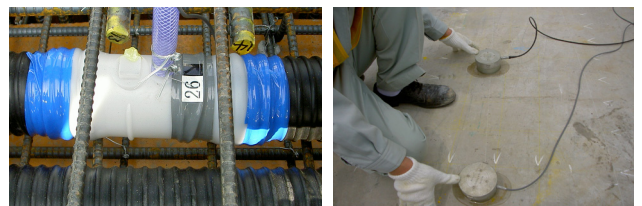
写真-3 充てん確認試験 (左:MS 右:超音波)
