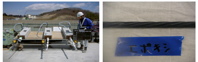
写真-2 暴露試験状況 (左:供試体 右:エポキシ結果)
