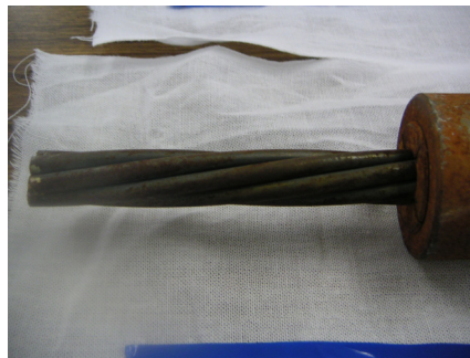
写真-19 試験結果(一次防錆)
