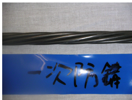
写真-16 試験結果(一次防錆)
