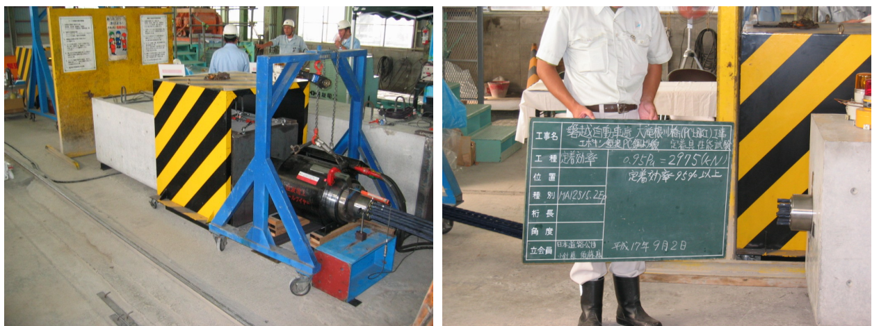
写真-4 定着具とPC鋼材を組み合わせた性能試験状況(Max時)
