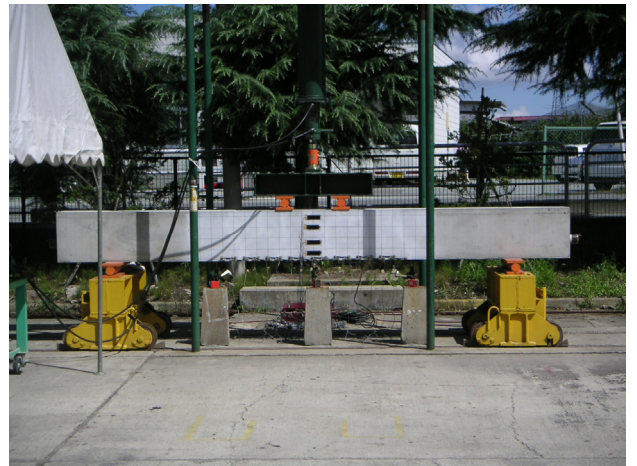
写真-9 供試体載荷状況
