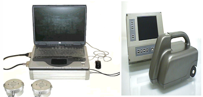
写真-24 計測機械 左：広帯域超音波装置 右：地中探査レーダー（鉄筋探査用）
