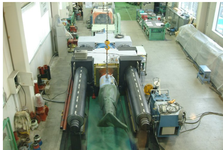
写真-8 10000kN 引張試験装置 (極東鋼弦コンクリート技術研究所試験装置)
