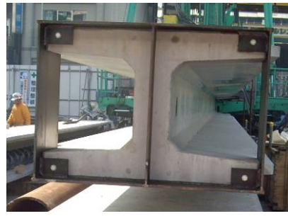
写真-26 刃口の改善
