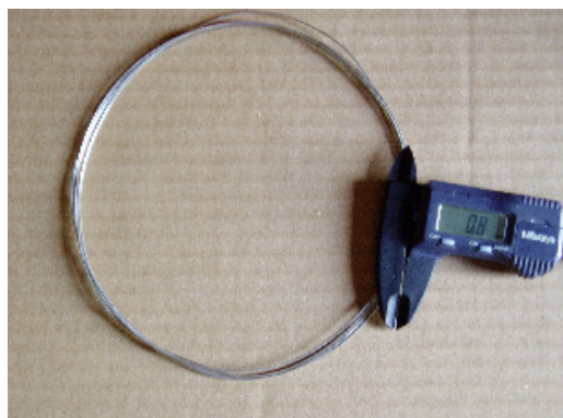
写真-9 プラチナ・ニオブ銅線(直径0.8mm)
