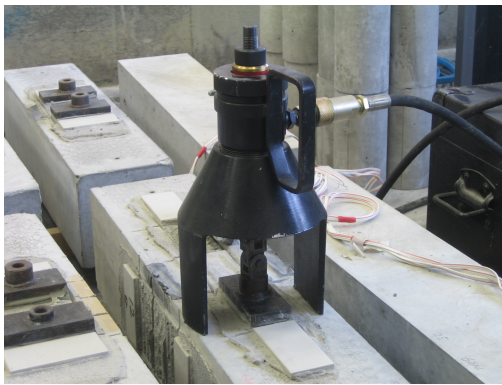
写真-2 引張実験状況
