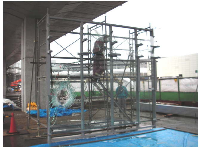
写真-4 ガラスモックアップ試験
