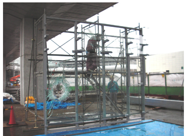
写真-13 ガラスモックアップ試験 *飛散防止フィルム貼付後 脱落及び飛散実験を行った。
