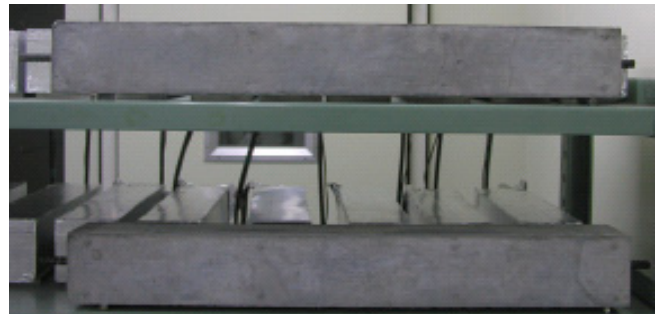
写真-1 鉄筋拘束試験状況
