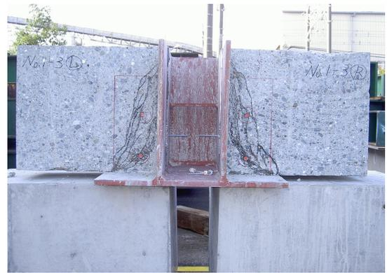
写真-2 切断面の破壊性状 (No.1-③供試体)
