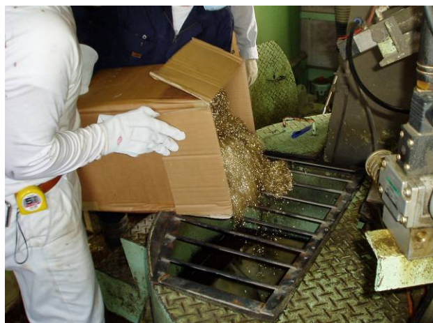
写真-5 スチールファイバー投入状況
