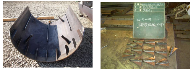
写真-3 先端閉塞型刃口とローラー付きスペーサー
