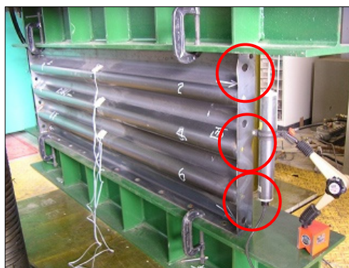
写真-5 変状 (Test-3)
