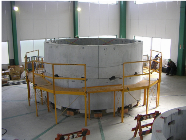
写真-3 水平仮組試験
