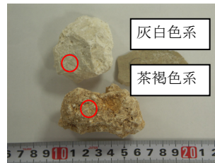
写真-8 骨材(大)試験体
