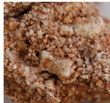
写真-5 茶褐色石灰岩の水浸部分
