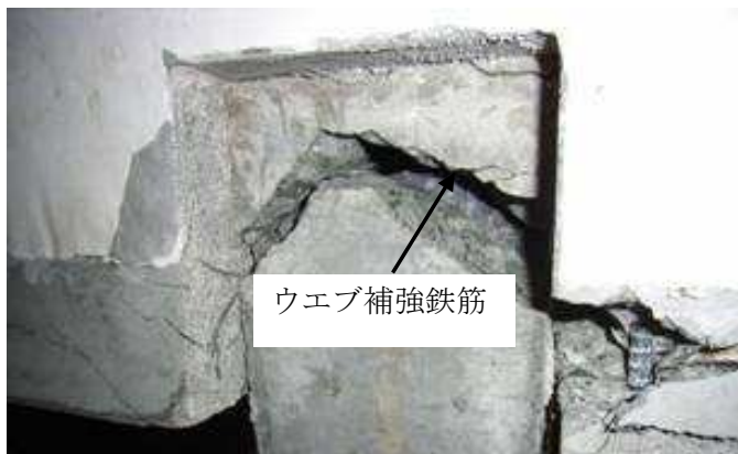
写真-6 C-H+SK ウェブ下面から見た破壊状況
