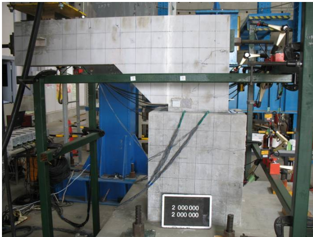
写真-1 供試体状況 (200万回載荷終了後)
