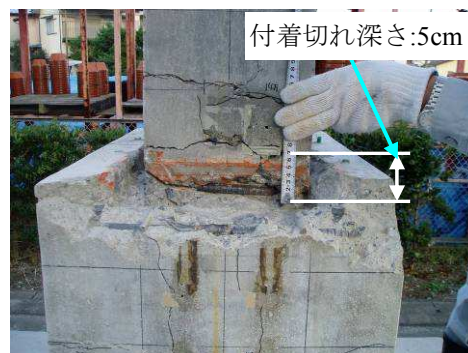
写真-4 ソケット部付着健全度の確認
