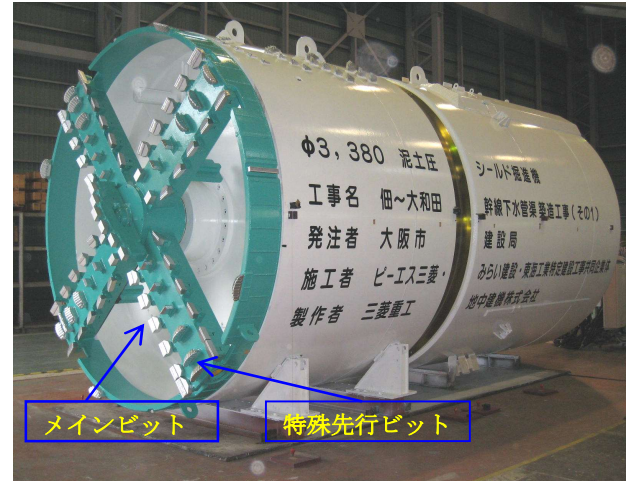
写真-3 泥土圧シールドマシン（工場完成時）
