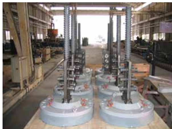
写真 - 5 ユニット支承の受入状況
