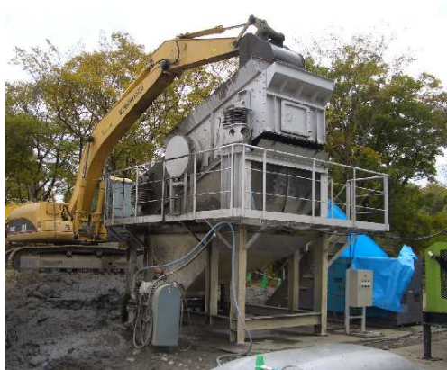
写真－5 充填土砂前処理設備
