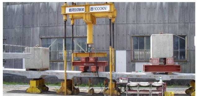
写真-1 曲げひび割れ試験
