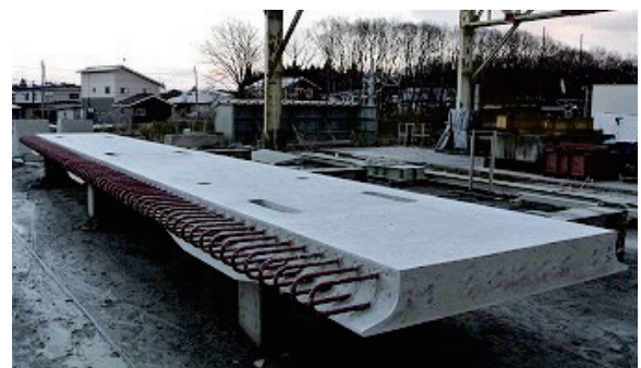
写真-2 PCaPC 床版試験部材の外観
