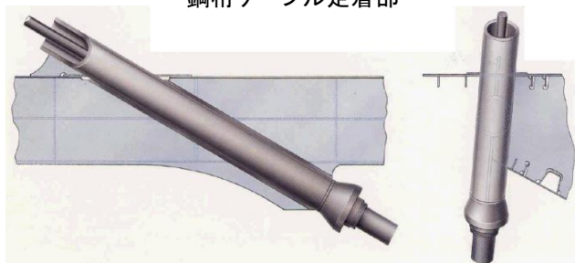
鋼桁ケーブル定着部
