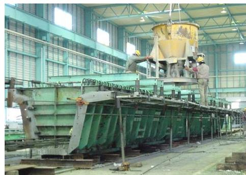
工場でのプレテンション桁の製造
